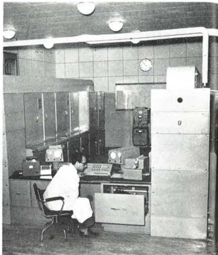
L'elaboratore elettronico del Consiglio Nazionale delle Ricerche sopra fotografato è stato il primo complesso del genere funzionante in Italia — in quanto venne installato nel 1955 — e ripete nello schema costruttivo i modelli dei primi elaboratori americani (contiene ben 3800 valvole). Si tratta di un calcolatore digitale con « memorie » prevalentemente dinamiche; essendo stato progettato per lavori scientifici « legge » da una zona di carta perforata e « scrive » o su un'altra zona perforata o su una macchina da scrivere (gli organi di scrittura sono visibili a destra; sul tavolo si trova il perforatore della zona, mentre nel sottostante cassetto è installata la macchina da scrivere)
