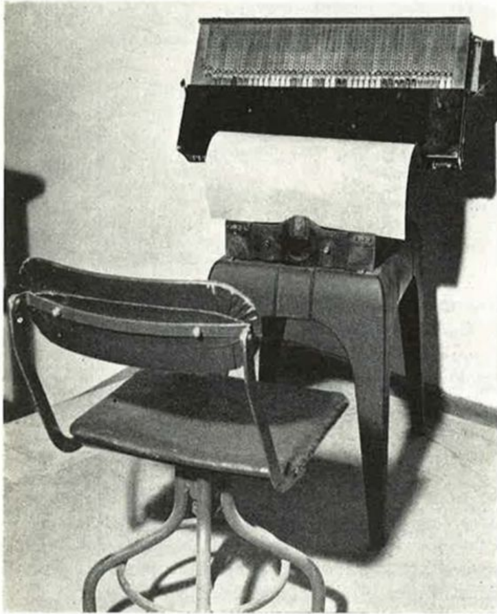
Due epoche a confronto. Le macchine riprodotte nelle fotografie sopra riportate sono, entrambe, perforatrici; quella di sinistra faceva parte del primo impianto dell'Istituto, quella di destra appartiene all'impianto attuale. Poco più di 40 anni intercorrono tra i due modelli, eppure il primo è già divenuto un esemplare da museo storico della meccanografia; perforava schede a non più di 45 colonne e l'impostazione dei punzoni di perforazione era affidata a 45 scorrevoli da posizionare ognuno sulla cifra che si voleva perforare. Oggi si perforano schede a 90 colonne mediante una tastiera praticamente uguale a quella di una comune macchina da scrivere.
