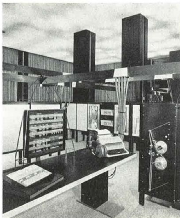
Una veduta parziale dell'Elea 9003 funzionante presso il Centro di Calcolo elettronico Olivetti in Milano; in primo piano si vedono il tavolo di comando (al centro) ed il lettore di nastro perforato (a destra), mentre in secondo piano si scorgono i lettori di nastri magnetici
