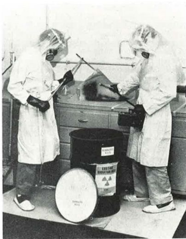
Simili ad uomini di un altro mondo, gli esperti di una « squadra volante » di decontaminatori rimuovono pericolosi materiali radioattivi da un laboratorio dove si è verificato un « versamento ». Indossando vestiti protettivi ed usando attrezzi speciali e contatori, essi raccoglieranno il materiale in una cassa, in ottemperanza alle disposizioni della Commissione per l'Energia Atomica sui dispositivi di sicurezza
