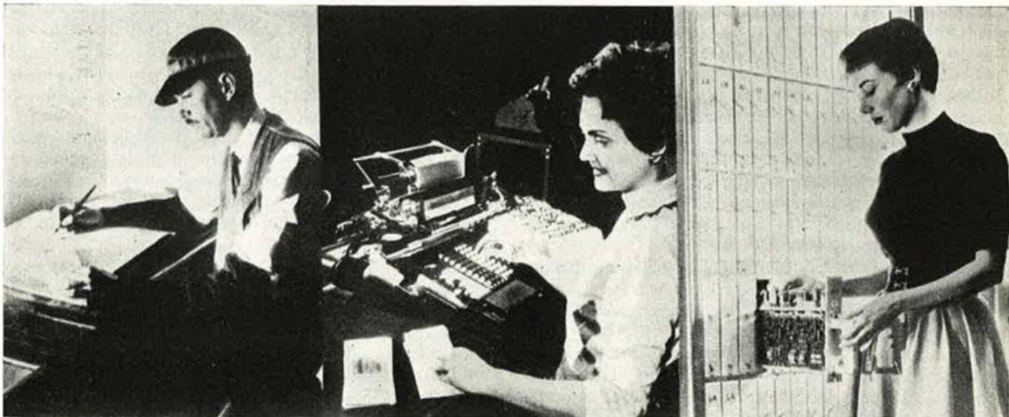
Ecco un rapido panorama dei progressi nel campo della contabilità: a sinistra il classico ragioniere che fa i suoi conti con tanto di penna e inchiostro; in mezzo, l'impiegata che manovra la odierna calcolatrice elettrica; a destra, la nuova calcolatrice elettronica che è stata costruita per la Banca d'America dallo « Stanford Research Institute » di Menlo Park in California, e che può completare ogni giorno i particolari della contabilità di 50.000 conti correnti.
