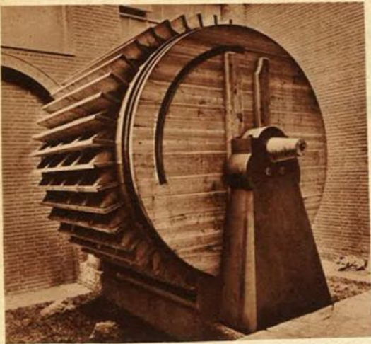
Macchina soffiante idraulica a cilindro rotante. L'interno del cilindro è diviso in quattro settori da due diaframmi. È mezzo pieno di acqua, la quale passa, durante la rotazione del tamburo, da un settore all'altro attraverso valvole e scaccia l'aria contenutavi attraverso il mosso.
